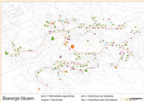
Netzplan Wärmenetz Häusern, Baubeginn 2022
